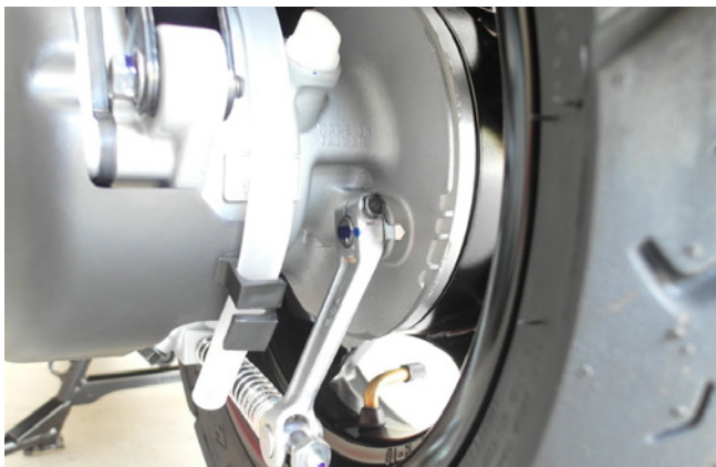
▲ 鼓式煞車示意圖。
