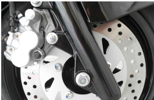
▲ 碟式煞車示意圖。
